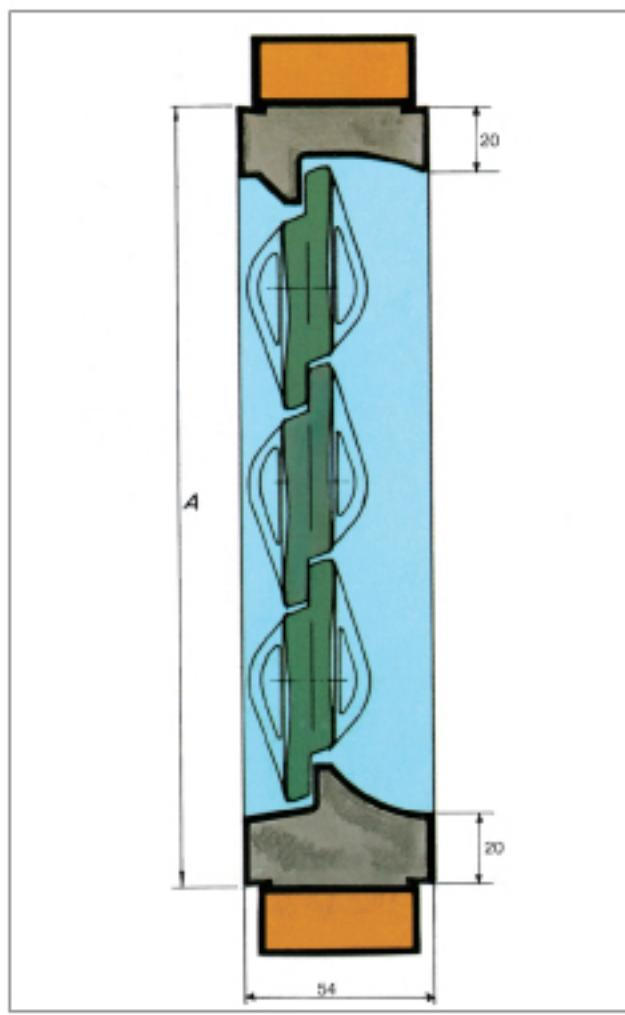
La celosía GRANDPANEL 80 está formada por lamas tubulares de aluminio aleación especial recubiertas con pinturas termoendurecidas altamente resistentes a la intemperie. Está disponible en colores de nuestra gama GRADCOLORS. Las lamas pueden girar desde 0° hasta 125°, logrando así controlar la entrada de luz a voluntad, o pueden ser fijas a una inclinación determinada.
